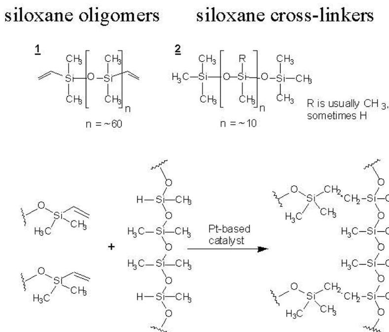
**Figure 4.** PDMS polymer and cross-linker.
