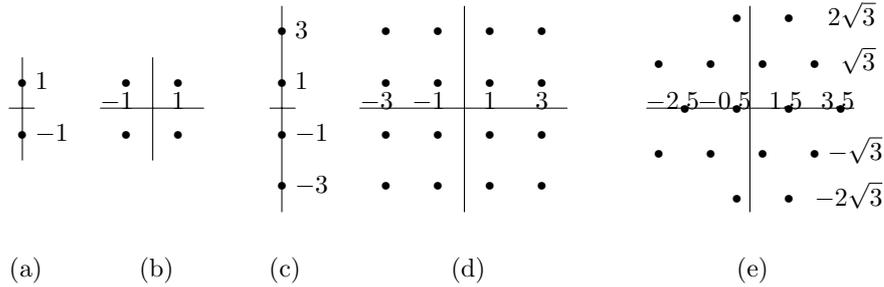
Figure 1. Uncoded signal constellations: (a) 2-PAM; (b)  $(2 \times 2)$ -QAM; (c) 4-PAM; (d)  $(4 \times 4)$ -QAM; (e) hexagonal 16-QAM.
