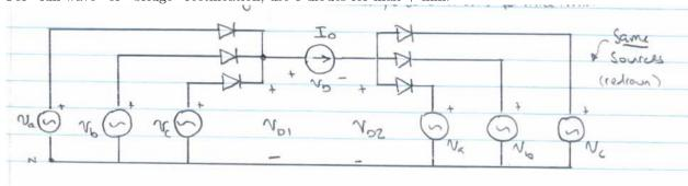
$$v_d = v_{D1} - v_{D2} = max [v_a, v_b, v_c] - min [v_a, v_b, v_c]$$
